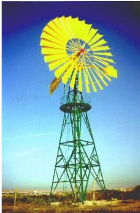
**Figura 1.2 - Turbina ad asse orizzontale lenta**
