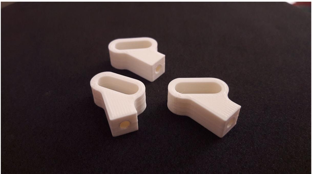
**Figura 5.25 - Asole realizzate in Nylon-Carbon tramite stampa 3D**
