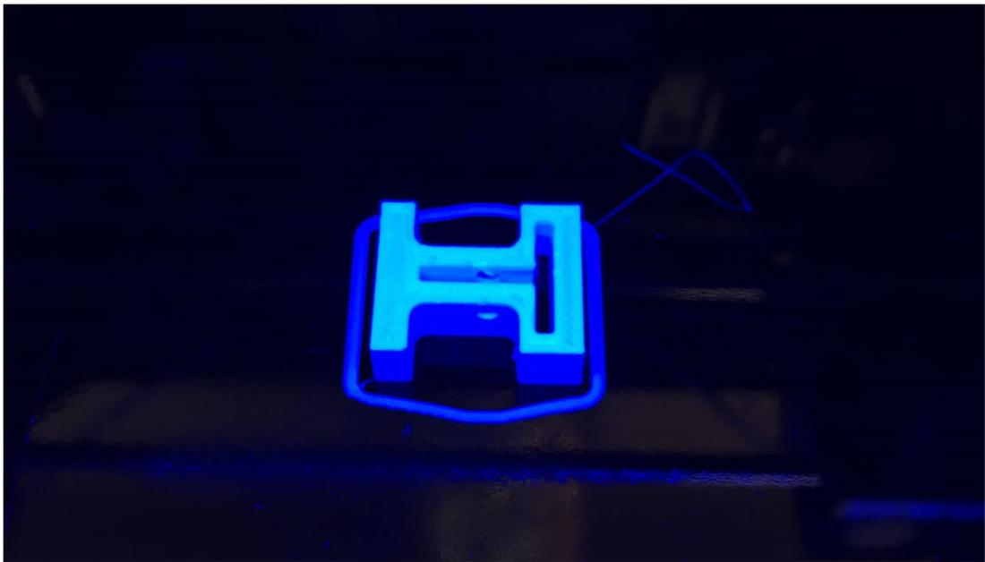
**Figura 5.16.a - Fasi di stampa 3D degli elementi di connessione dei bracci delle pale a resistenza**
