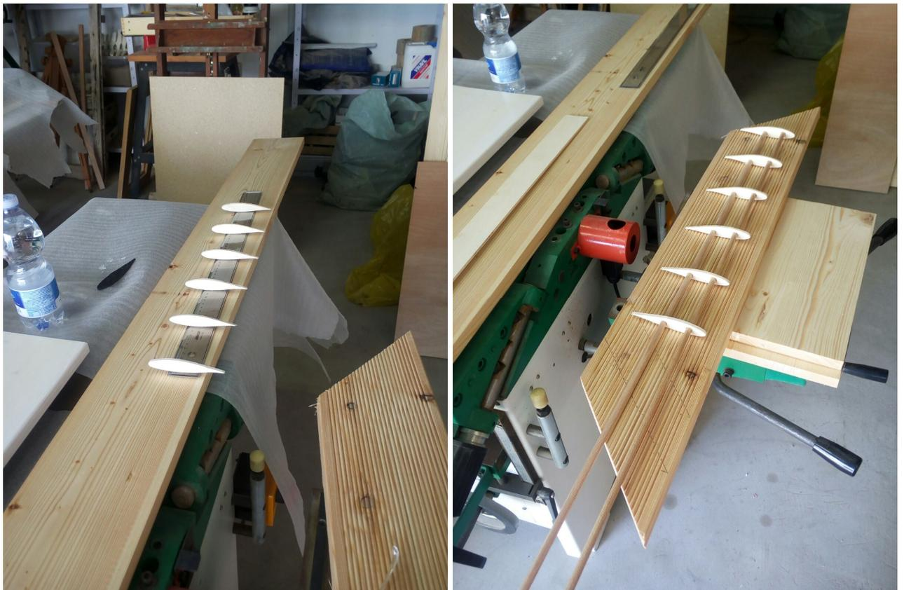
Figura 5.4 - Preparazione delle anime delle pale
