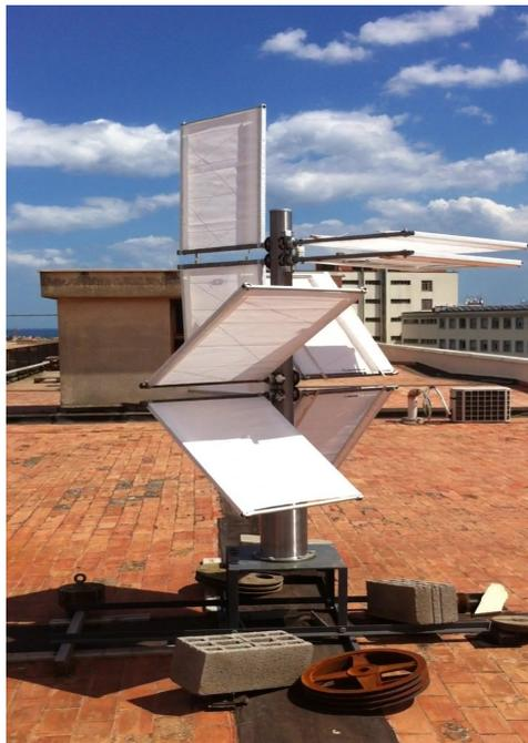
**Figura 1.11 - Prototipo di turbina Savonius a geometria variabile**
