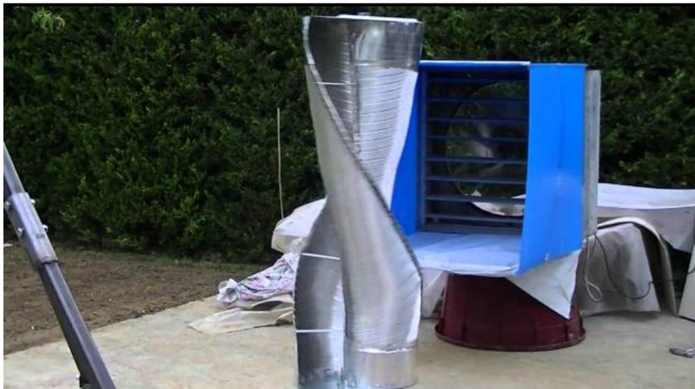
**Figura 1.4 - Turbina Savonius**
