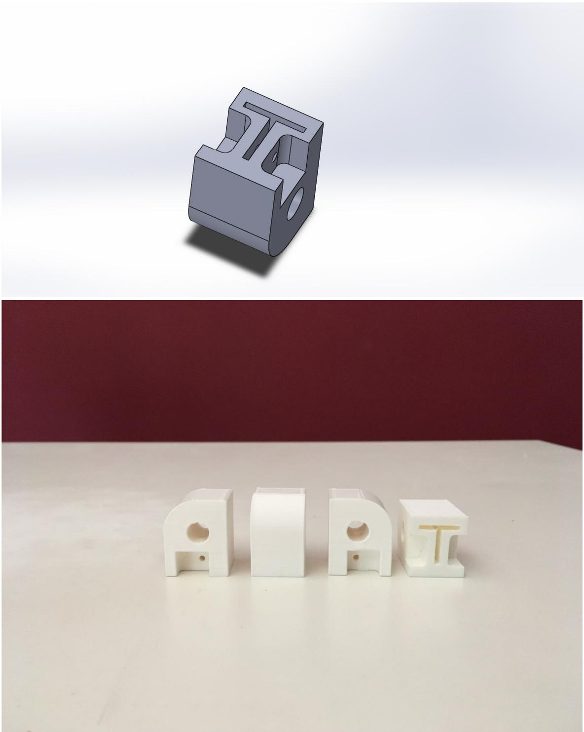
**Figura 5.15 - Confronto tra il modello CAD degli elementi di connessione dei bracci delle pale a resistenza ed i componenti realizzati in fibra di Nylon-Carbon tramite stampa 3D**
