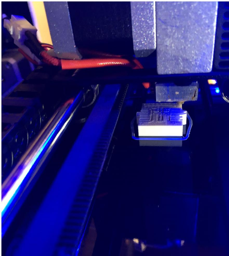
**Figura 5.16.b - Fasi di stampa 3D degli elementi di connessione dei bracci delle pale a resistenza**
