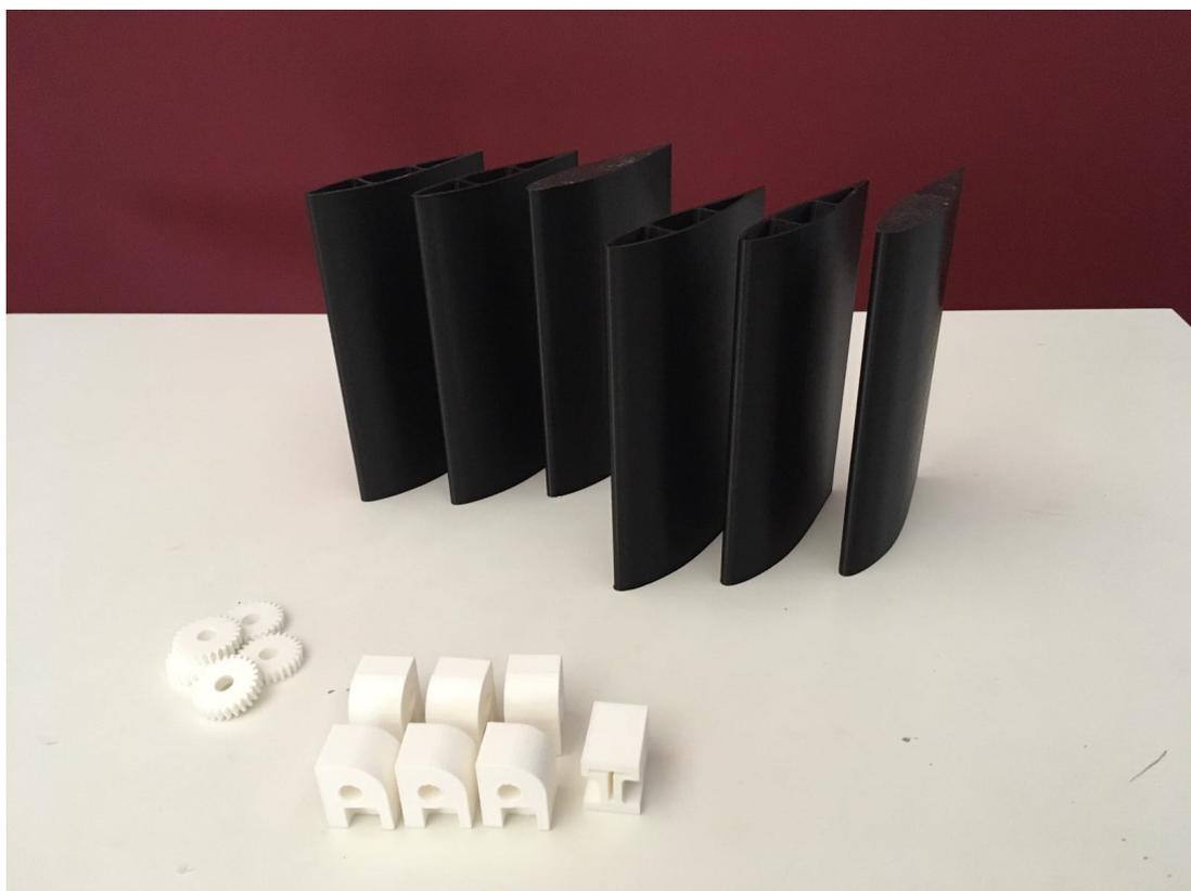
**Figura 5.7 - Pale ed altri componenti realizzati tramite stampa 3D**
