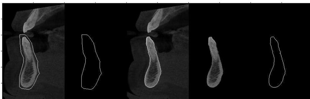
Fig. 2.47: a) posizionamento dello Snake, b) solo curva di Snake iniziale, c) risultato finale della curva dopo il ciclo di iterazioni, d) zona d'interesse isolata, e) solo curva di contorno finale.
