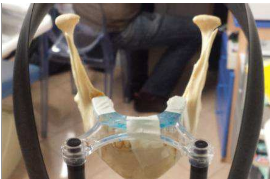
Fig. 2.34: Mandibola montata sul bloccamorso per l'acquisizione.
