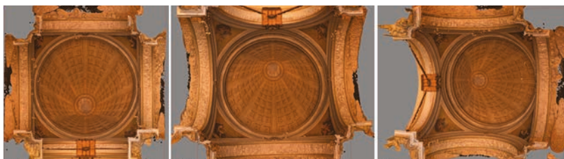
Fig. 7. Immagini estrapolate dal modello su Photoscan Agisoft dalle quali si evincono le aberrazioni dell'immagine prospettica in funzione del punto di osservazione.
