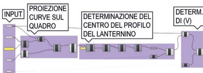
Fig 17. Rappresentazione grafica dell'algoritmo che itera il procedimento di proiezione dal centro V sul quadro \pi degli elementi architettonici costituenti la calotta ribassata.
