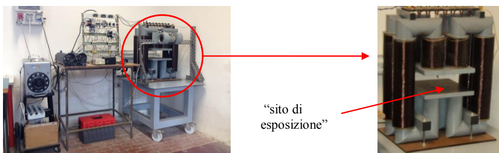
Fig. 1 – Apparecchiatura, realizzata ex-novo, per la realizzazione di un "sito di esposizione" delle specie vegetali al campo magnetico ELF di valore noto e controllabile.
