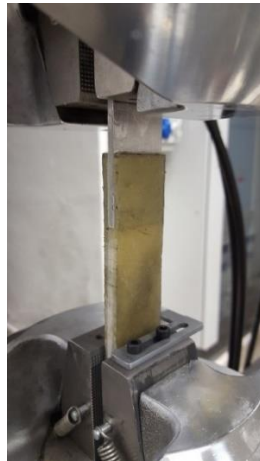
Figura 3. Prova di trazione di un provino con inserto in alluminio e lunghezza doppia di sovrapposizione
