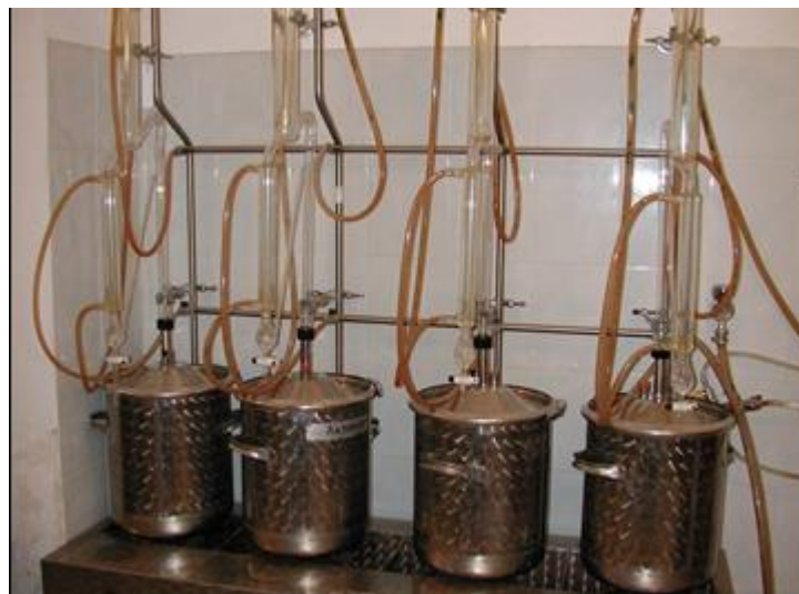
Figura 3: Distillatore in corrente di vapore (Albrigi) impiegato per l'estrazione degli oli essenziali.
