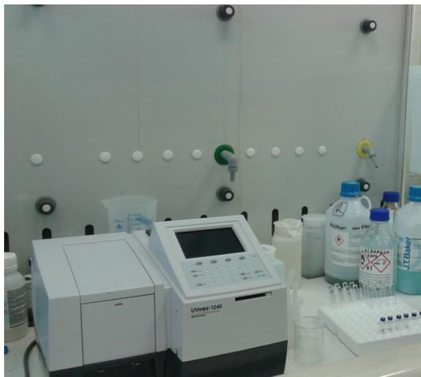
**Figura 3.4.2** Spettrofotometro uv-visibile (IAMC-CNR) Capo Granitola.
