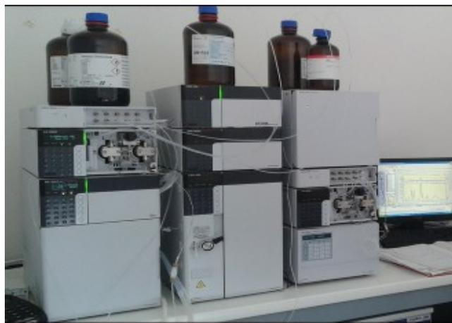
**Figura 3.5.2 3** - Sistema HPLC usato per le analisi di aminoacidi.
