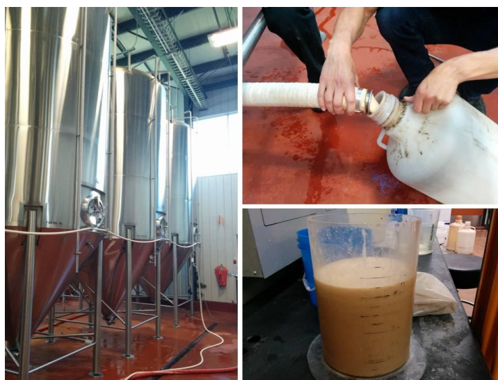
Fig.7.1: Immagine del campionamento del refluo prelevato dal fondo dei fermentatori
