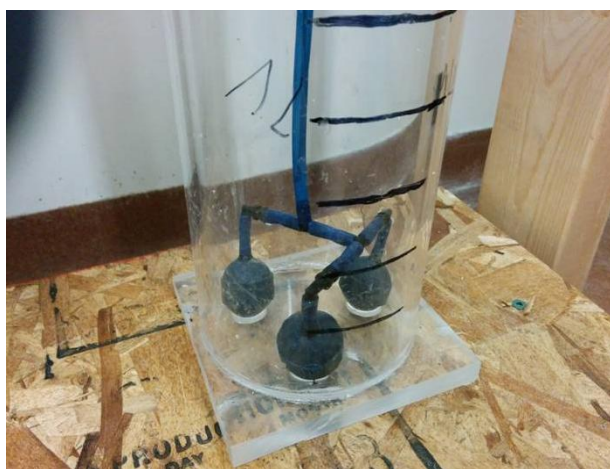
Fig.7.3: Particolare dei diffusori d'aria sul fondo dei reattori
