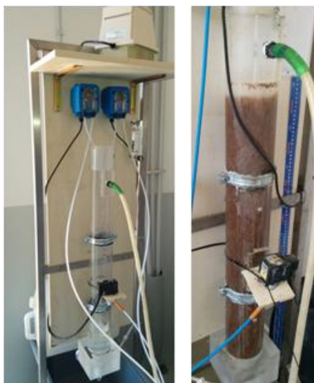
Figura 6.2: Immagini del reattore SBAR utilizzato per la sperimentazione
