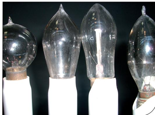
Fig. 3. Lampade a incandescenza usate come sorgente di radiazione infrarossa.
