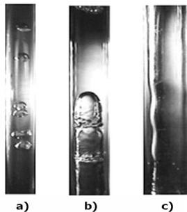
**Figura 6.17.** Confronto tra gli effetti di diversi flussi d'aria sulla distribuzione delle bolle all'interno della membrana (doc. Pentair).
