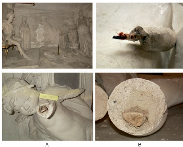
Figura 3. La struttura di legno e la successione dei diversi strati di stucco nelle statue danneggiate provenienti dall'Oratorio di S. Mercurio (A) e dal Monastero delle Stimmate (B). Fascicolo tecnico per l'archiviazione elettronica dei risultati delle analisi mineralogico-petrografiche.
