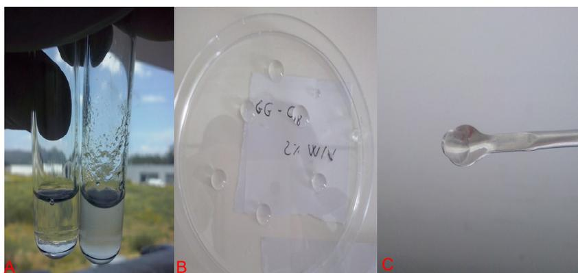
**Figura 46.** **A)** Soluzione acquosa di GG-C<sub>18</sub> (2) (sinistra) e dispersione acquosa del GG (destra) entrambi al 2% p/v dopo un giorno a 37 °C sotto costante agitazione; **B)** gocce della soluzione acquosa di GG-C<sub>18</sub> (2) a temperatura ambiente; **C)** *hydrogel* di GG-C<sub>18</sub> (2) ottenuto in PBS 1x
