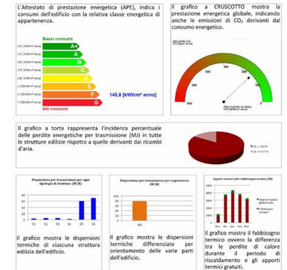
Fig. 3 Prestazione energetica dell'edificio oggetto dello studio (Fonte: [14]).
