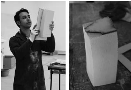
8. Controllo della curvatura di un concio per mezzo del baibel (a sinistra) e posizionamento della sagoma di testa (a destra).
