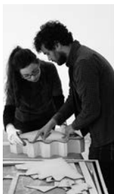
13-15. A sinistra, collegamento della sezione superiore e inferiore di alcuni elementi del tas-de-charge , al centro, definizione delle superfici a vista di un elemento del tas-de-charge ; a destra, i quattro filari n. 6 dei tas-de-charge pronti per la posa in opera.
