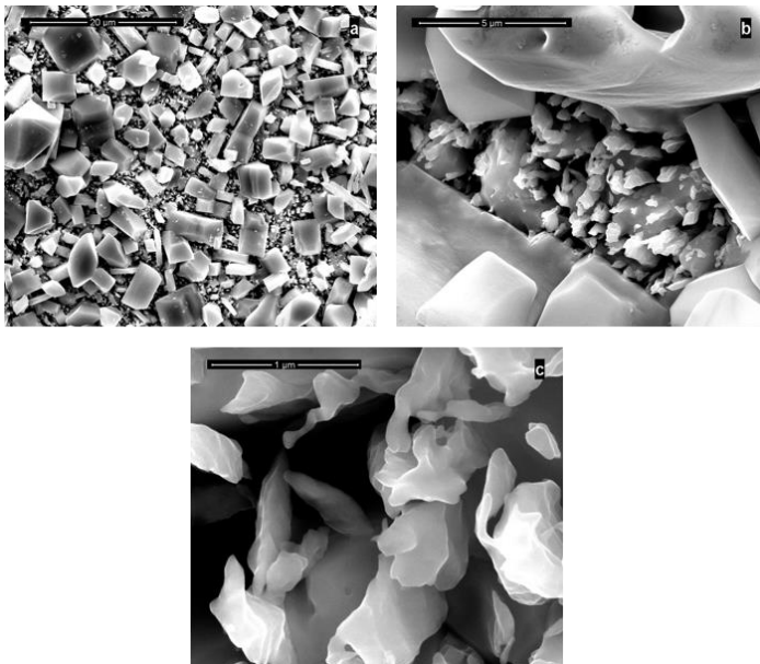
Figura 3.23: Micrografie a diversi ingrandimenti dell'elettrodo dopo ciclizzazione a 5C.
