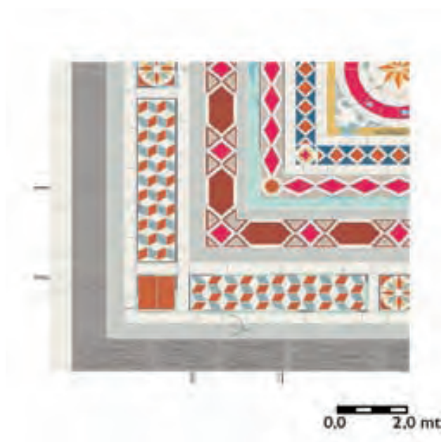
Fig. 14 - Bagheria, Villa Palagonia, corpo centrale di fabbrica, piano nobile, rilievo della pavimentazione marmorea della «Sala degli specchi», particolare
