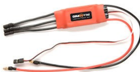
Figura 11. Tipico regolatore ESC per multicotteri
