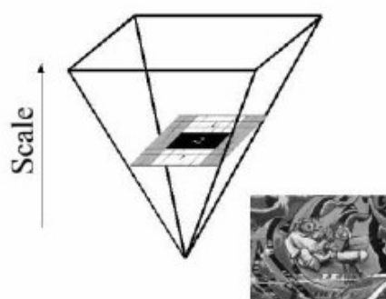
Figura 78. Uso delle immagini integrali permette di incrementare le dimensioni del filtro e mantenere costanti quelle dell'immagine
