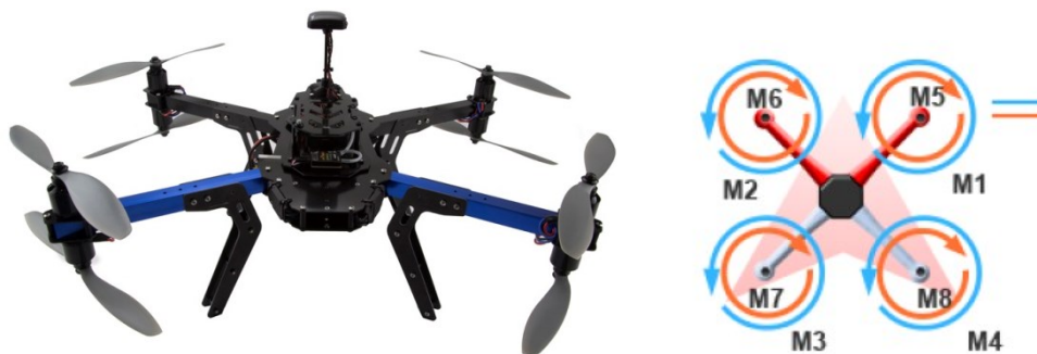
Figura 22. Quadricottero doppio: (a) modello reale; (b) schematizzazione
