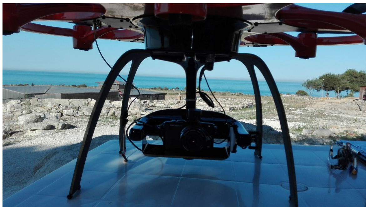
Figura 136. Installazione della camera sul gimbal
