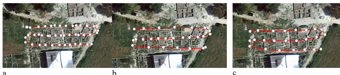
Figura 142. Voli a 25 m: (a) scatto sui Waypoint; (b) scatto ad intervallo di tempo; (c) scatto ad intervallo di tempo dimezzato
