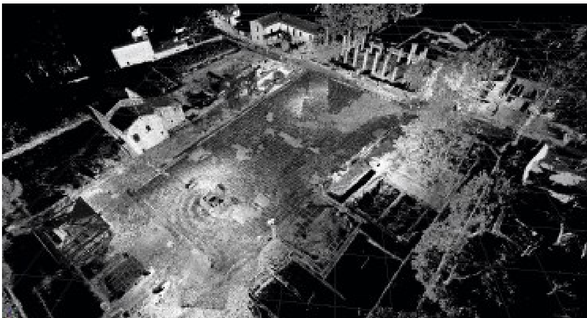
Figura 100. Nuvola di punti acquisita tramite laser scanner
