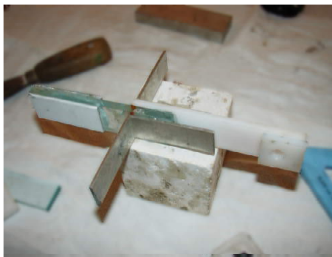
Figura 5: Campione di prova per la verifica di incollaggio vetro/POM-C Figure 5: Test sample for the assessment of the glass/POM-C bonding
