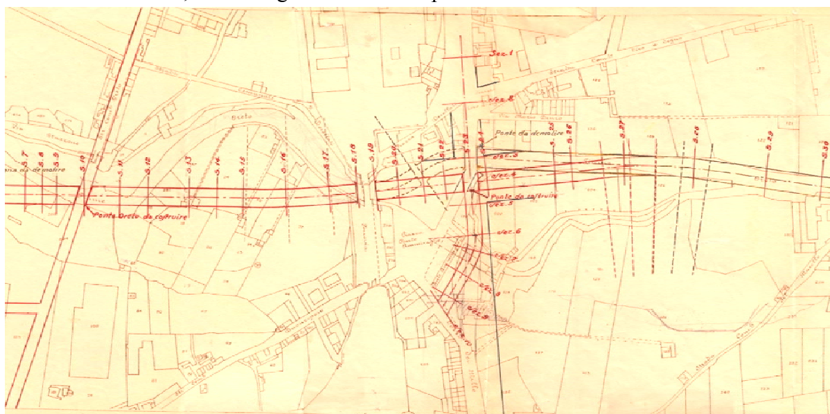
Figura 26 a) planimetria generale del progetto realizzato, che evidenzia la rettificazione di buona parte del corso inferiore dell'Oreto, compresa la modifica del tratto interessato dal ponte delle Teste.
