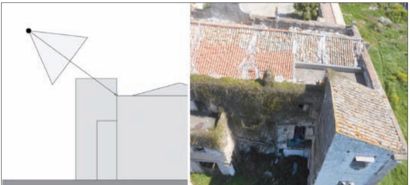
**Figura 8** - Esempio di prese inclinate in ambito architettonico.
