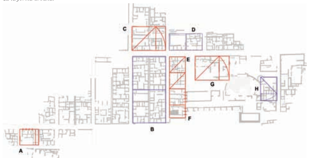
Fig. 11 - Individuazione dei rapporti armonici in corrispondenza delle Insulae: A) terza minore (5:6); B) diapason (1:2); C) diagonea (1: \sqrt{2} ); D) diapason (1:2); E) angolo di 45° (1:1); F) doppio diapente (4:9); G) sezione aurea (1:φ); H) diagonea (1: \sqrt{2} ).
