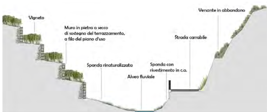
Figura 1 | Sezione-tipo di terrazzamento intorno agli argini fluviali con vigneto.
