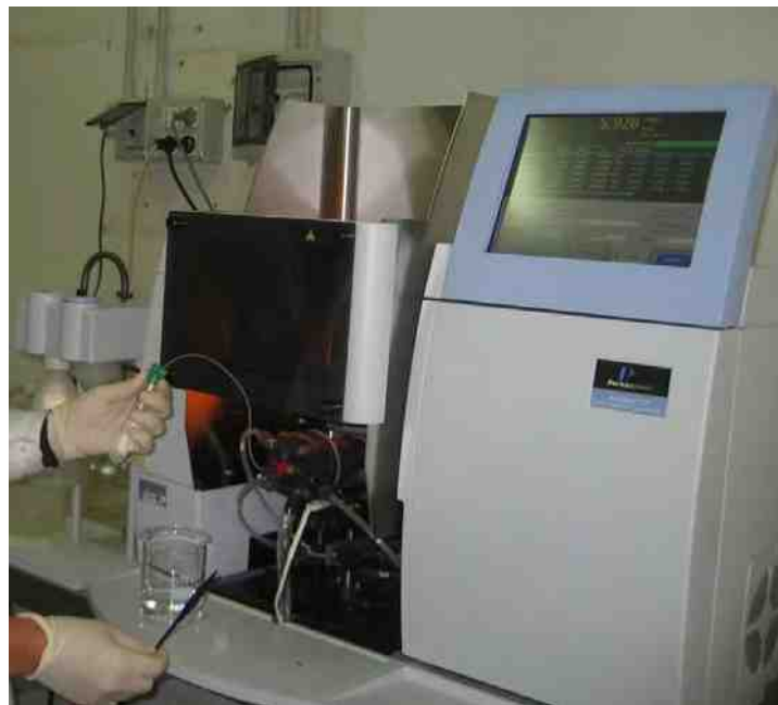
Figura 27: Lettura dei campioni mediante spettrometro ad assorbimento atomico (AAAnalist 200, Perkin Elmer).
