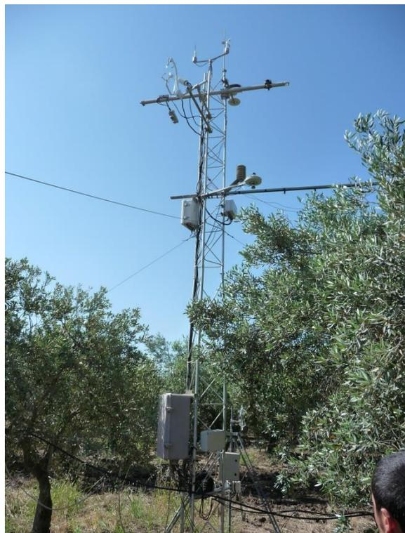
**Figura 4.6 - Immagine dell'installazione per la misura dei flussi energetici**
