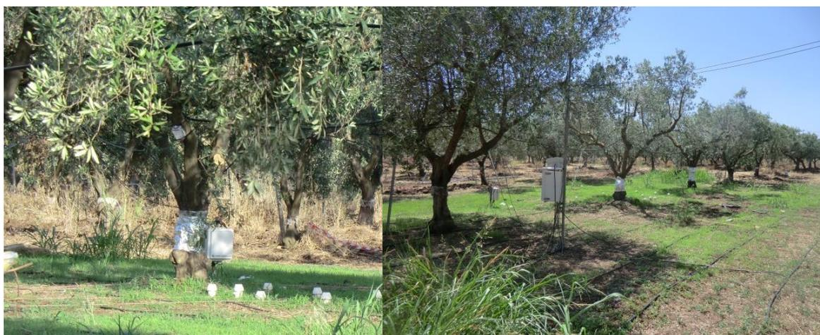
**Figura 4.11 - Stazione per la misura dei flussi linfatici e vista del datalogger di installazione**
