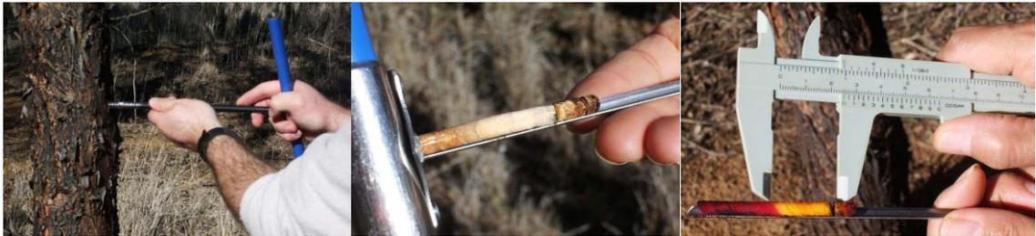
**Figura 3.4 - Metodo diretto per la misura dello spessore del sapwood**
