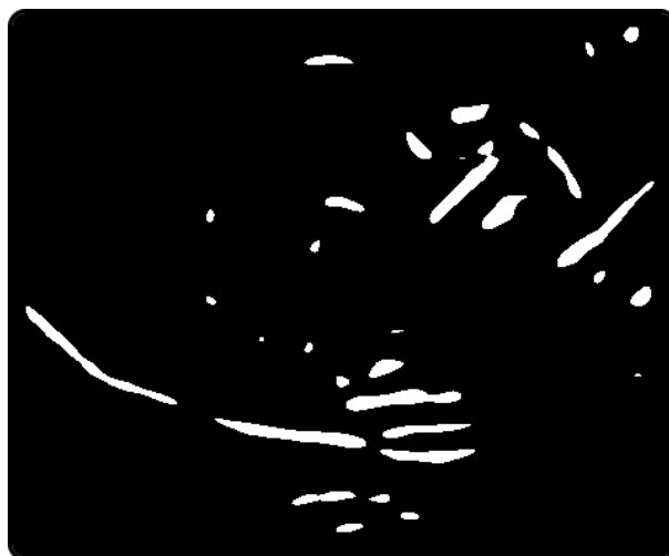
Figura 3.15: Negazione del piano wavelet già binarizzato.
