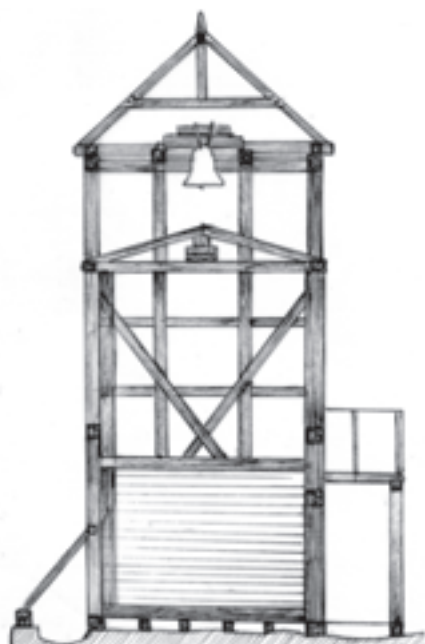
Fig. 11 - Sezione longitudinale del campanile. [40]
