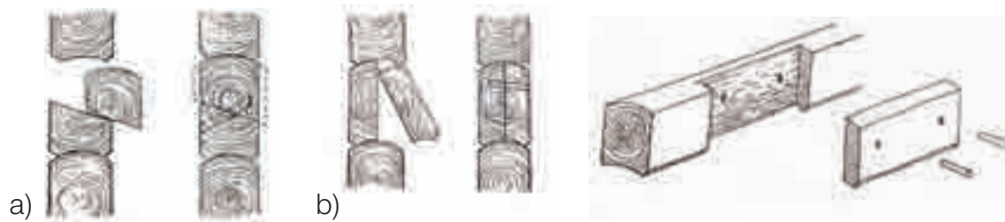
Fig. 35 – Le protesi possono essere montate obliquamente (taglio verso il baso nel lato esterno), come è dimostrato in questo disegno (a), successivamente gli elementi vengono rinforzati tramite chiodi lignei. La protesi può essere inserita con i bordi più larghi, che dopo l'inserzione vengono lavorati all'ascia e allineati. Nel caso di protesi parziale (b) il midollo deve essere orientato verso l'interno. [2]
