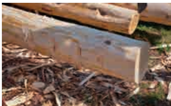
1.13, 1.14 - In entrambe le estremità dei tronchi viene segnata una linea perpendicolare di taglio, tramite una lenza impregnata di carbone. Si tagliano le scanalature perpendicolarmente alla direzioni di taglio longitudinale, così, in questo modo, si facilita il lavoro con l'ascia.
