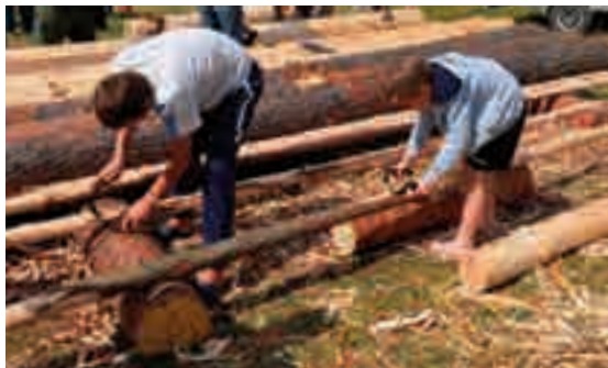
2.1, 2.2 - Scortecciatura dei tronchi sottili tramite scortecciatrice ed asce;
