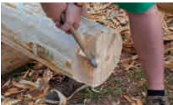
1.11, 1.12 - Il dente viene ottenuto con seghe, asce e scalpelli. Se nella zona di taglio ci sono dei rami è preferibile lavorare con la sega, perchè l'ascia, meno precisa, può rimuovere parti di legno utile.
