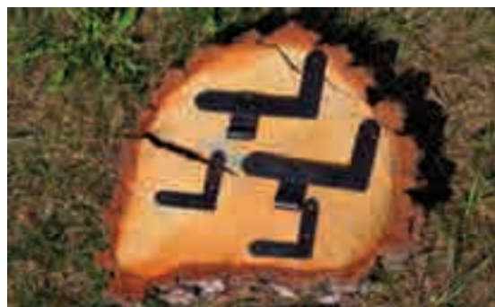
3.5, 3.6 - Successivamente sono rimosse dal fuoco e subito pulite con una spazzola metallica al fine di rimuovere vernice e ruggine. Subito dopo si applica su di esse uno strato a base di resina di pino (catrame vegetale di resina di pino). La superficie metallica da lavorare deve essere molto calda, perchè così il catrame applicato evapora ed asciuga immediatamente. Ed in questo modo, le parti metalliche risultano rinnovate e protette dalle ruggine.
