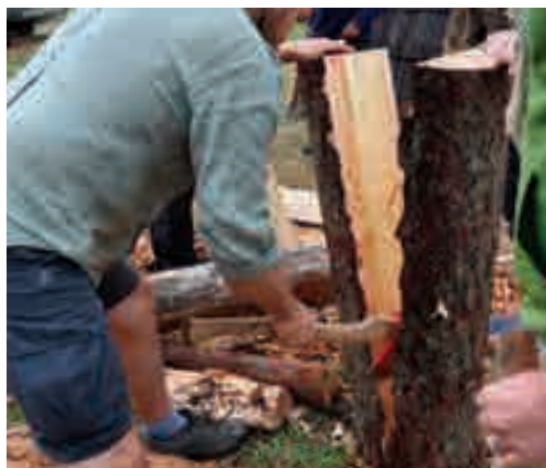
4.1, 4.2 - Il tronco, di giusta altezza, si taglia in due parti, mediante una o due asce e a colpi di mazzuolo.
