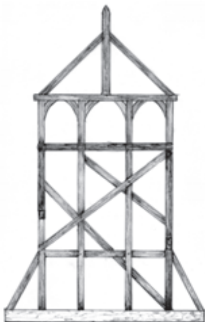
Fig. 7 - Sezione longitudinale del campanile.
