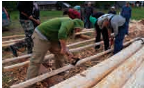
2.1, 2.2 - Scortecciatura dei tronchi sottili tramite scortecciatrice ed asce;
