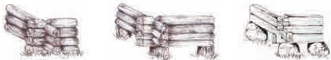
Fig. 1 - Tipi di fondazioni: la struttura dei setti poggiate direttamente sul terreno, fondazioni realizzate con i tronchi di conifere o di quercia e grandi blocchi di pietra isolati.
