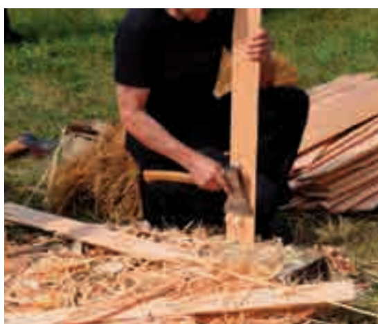
4.5, 4.6 - La tavola viene separata accuratamente dalla corteccia. Ogni tavola viene rifinita tramite un'ascia ed è così pronta per l'utilizzo. La corteccia rimossa nella lavorazione si recupera e viene utilizzata per il riscaldamento di abitazioni.
