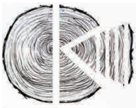
4.3, 4.4 - Ogni metà del tronco viene tagliata a sua volta in tre parti, ed ogni terza parte viene tagliata lasciando un triangolo utilizzato per i tronchetti di recinzione ed altre tavole sottili per il rivestimento della copertura.
