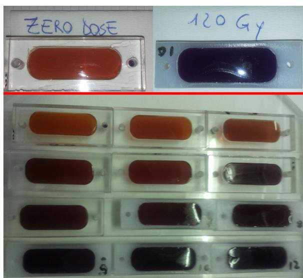
Figura 5.17: Foto di Gel di Fricke irradiati da 0 a  $144\text{ Gy}$  con fotoni da  $^{60}\text{Co}$ . In alto: a sinistra e a destra un campione non irradiato e uno a cui é stata impartita una dose di  $120\text{ Gy}$ . In basso: da sinistra a destra e dall'alto verso il basso Gel di Fricke irradiati con dosi crescenti.
