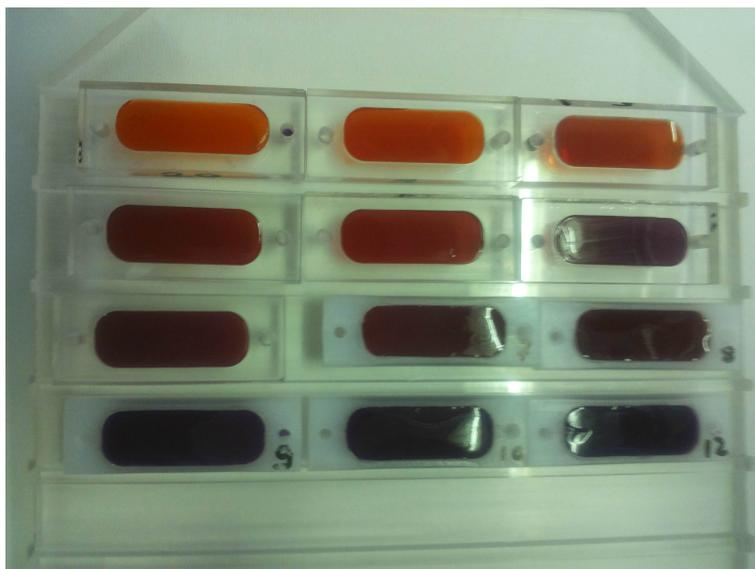
Figura 4.3: Dosimetri gel di Fricke irradiati con fotoni del <sup>60</sup>Co (dosi crescenti da sinistra a destra e dall'alto verso il basso - da 0 a 120 Gy).
