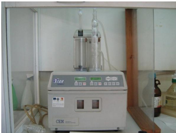
Figura 4.1: Forno a microonde con cavità aperte CEM STAR System utilizzato per la preparazione dei gel.
