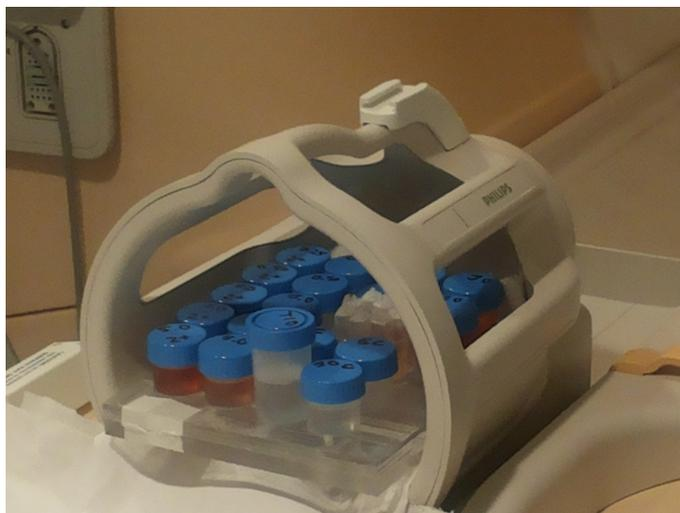
Figura 5.11: Foto delle soluzioni di Fricke all'interno della bobina per le acquisizioni MRI per encefalo.
