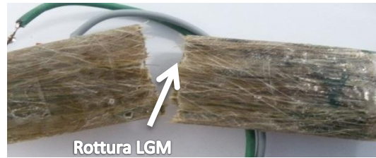
Figura 5: Modalità e superficie di rottura tipica degli skins esaminati in trazione.
