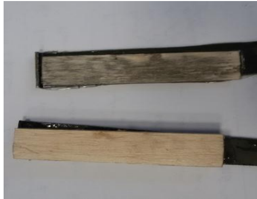
Figura 12: Meccanismo di rottura del sandwich con skins ASRN 4
