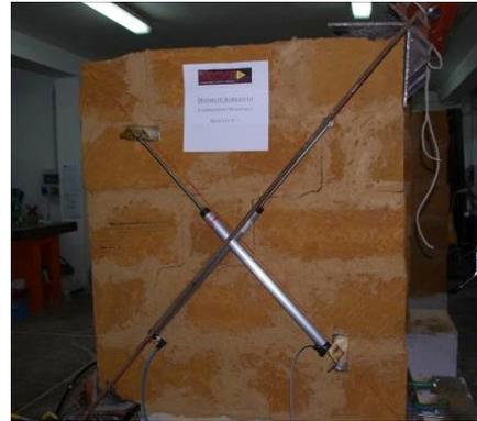
Prova di compressione diagonale – foto 12, 13
