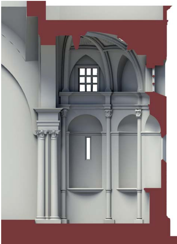
5. Chiesa di San Nicola a Cursi, sezione longitudinale del modello digitale del catino.
