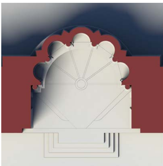
15. Chiesa di San Michele Arcangelo a Minervino, pianta alla quota del primo registro e sezione trasversale dell'abside.
