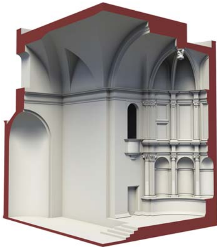
14. Chiesa di San Michele Arcangelo a Minervino, viste prospettica e assonometrica del modello tridimensionale dell'abside.
