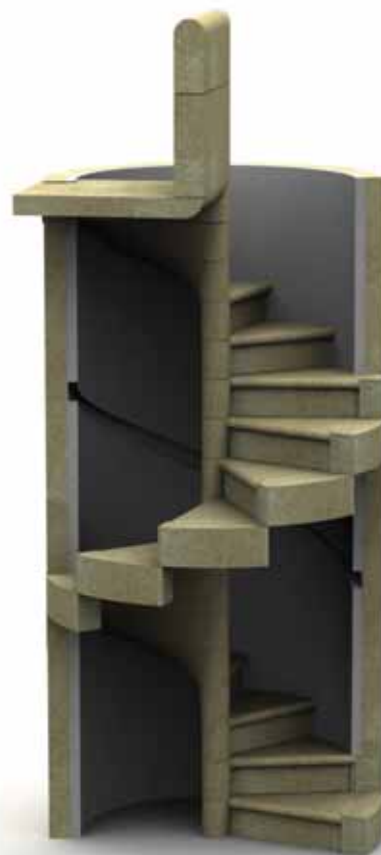
Fig. 8 Il caracol de husillo nel palazzo Reale di Palermo, modello digitale della scala.
