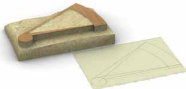
Fig. 9 Il caracol de husillo nel palazzo Reale di Palermo, dettaglio di un gradino e delle sagome utilizzate per il taglio.
