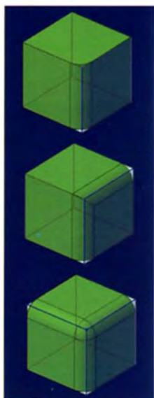
Fig. 192 Raccordo di spigoli e raccordo di superfici. Smusso di uno spigolo isolato, di due spigoli contigui, di tre spigoli contigui.
