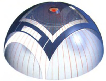
Fig. 162 Fabrizio Avella, schema geometrico del sistema di volte del Palazzo dei Congressi a Salamanca di Juan Navarro Baldeweg. Le volte sono ottenute dalla sezione di porzioni di una superficie sferica.
