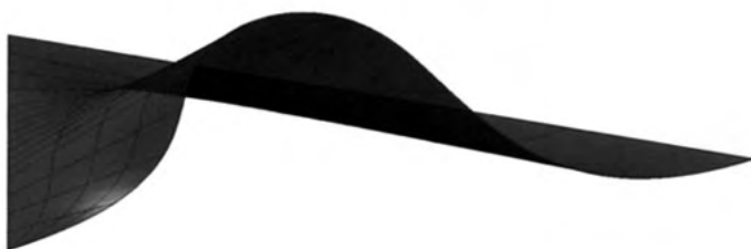
Fig. 149 Superficie loft ottenuta da interpolazione di un segmento retto ed una curva policentrica.
