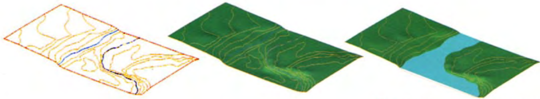
Fig. 135 Ricostruzione di una porzione di territorio tramite interpolazione di curve di livello delimitate da curve di bordo.
