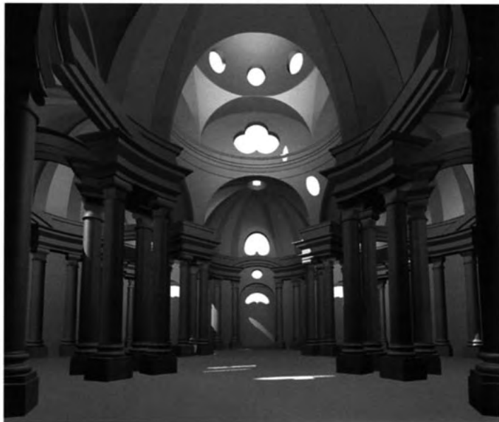
Fig. 121 Fabrizio Avella, ricostruzione della chiesa di S. Filippo Neri di G. Guarini. La complessità spaziale di quest'opera è ottenuta da sapienti composizioni di solidi di rotazione: le colonne, il tamburo, la cupola centrale sono elementi architettonici ottenuti tramite rivoluzione di profili.
