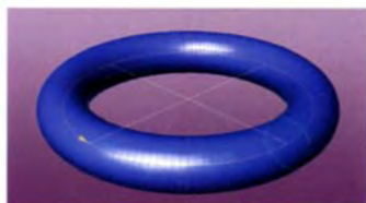
Figg. 116 - 118 Toro o anello. La forma è ottenuta tramite rivoluzione di una circonferenza il cui piano di giacitura comprende l'asse di rotazione.
