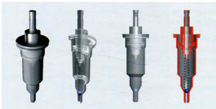
Fig. 115 Saverio Albano, ugello per soap dispenser. In rosso è evidenziata la sezione dell'oggetto che determina la forma del solido di rotazione.
