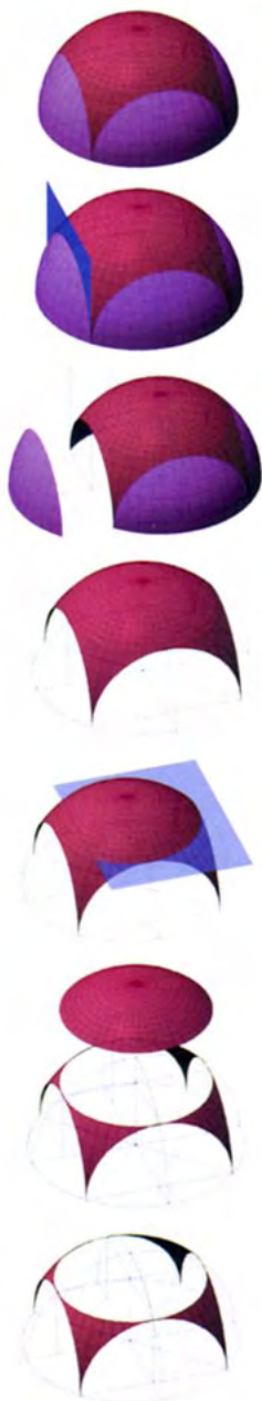
Figg 155 - 161. Genesi geometrica della volta a vela e dei pennacchi sferici.
