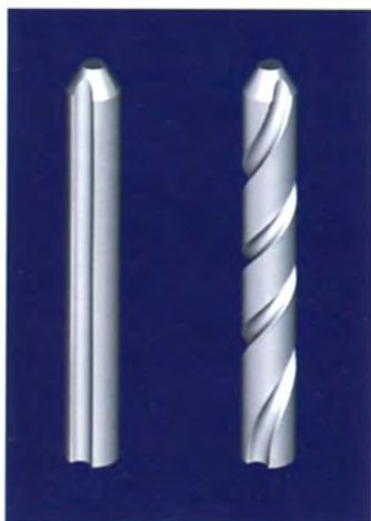
Fig. 211 Torsione di un cilindro con punta tronco-conica scanalato. L'esito della torsione di un solido di rotazione scanalato può generare una forma simile a quella della punta di un trapano.
