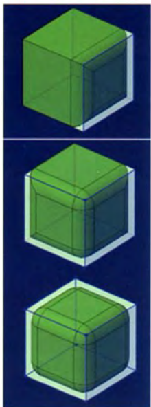
Fig. 193 Raccordo di spigoli e di superfici. Si osservi la differenza formale a seconda di quali spigoli sono compresi nell'operazione.
