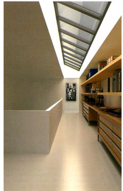
Fig. 315 Denise Ippolito, interno di un edificio residenziale. La morbidezza delle ombre è determinata dalla presenza di luce indiretta proveniente dal lucernaio.
