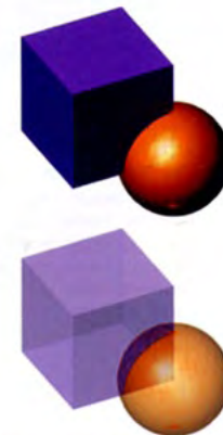
Fig. 242 - 243 Visualizzazione ombreggiata semitrasparente e a raggi x con visualizzazione della struttura geometrica e delle isocurve. Queste visualizzazioni permettono di comprendere gli aspetti formali e geometrici degli oggetti.
