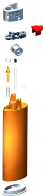
Fig. 40 Emanuele Cascone, accendino Bic, esploso assonometrico. La direzione prevalente per la traslazione degli elementi è quella verticale.
