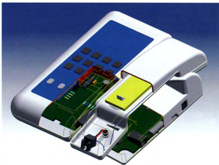
Fig. 77 Mariangela Laudicina, telefono Sirio, spaccato assonometrico. Due piani secanti, che non intersecano totalmente il modello, consentono di asportare parti del modello e renderne parzialmente visibile l'interno.
