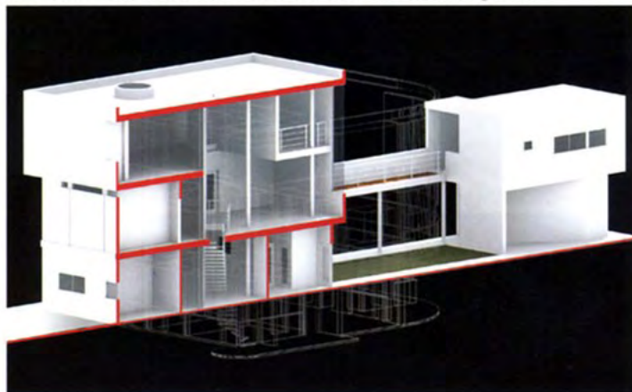
Fig. 75 Francesco Alessio De Marco, Casa Saltzman di R. Meier, spaccato assonometrico. La porzione del modello antistante il piano di sezione è raffigurata con sottili segni bianchi.
