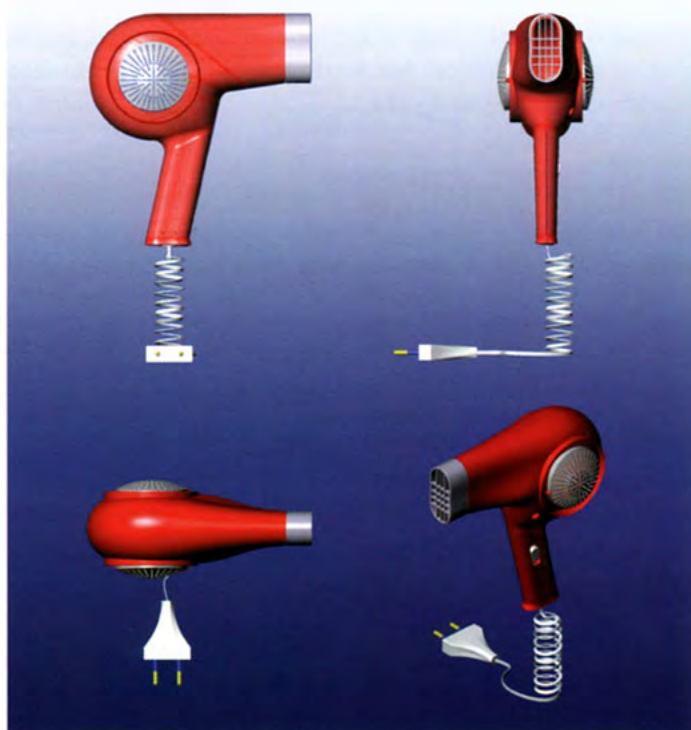
Fig. 21 Maria Guglielmini, Asciugacapelli, proiezioni ortogonali e assonometria, riportati secondo il sistema europeo, con l'eccezione del quadrante in alto a destra, in cui è invertito il verso di proiezione.
