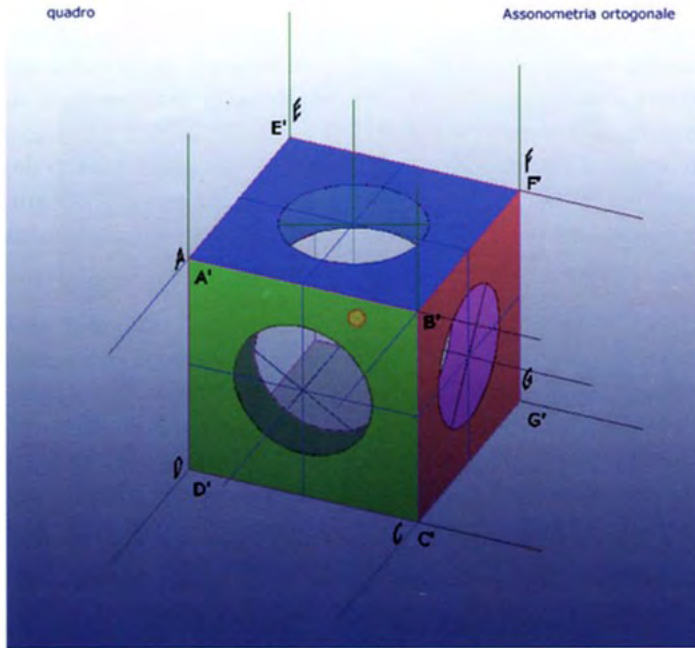
Fig. 36 Assonometria ortogonale di un solido.
