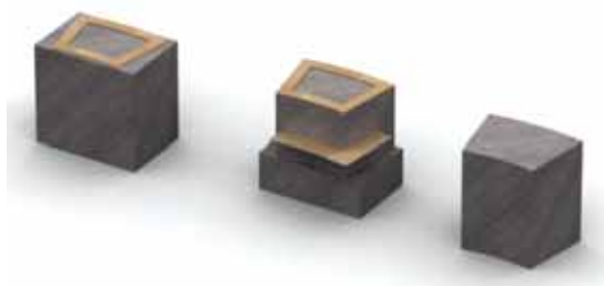
Fig. 4 Simulazione dei tagli di un concio lapideo par équarrissement , (tratto dalla tesi di laurea di M. Cannella, Temi di stereotomia a Palermo , Facoltà di Architettura di Palermo, a.a. 2005/06, Relatore, Prof. Arch. F. Agnello).
