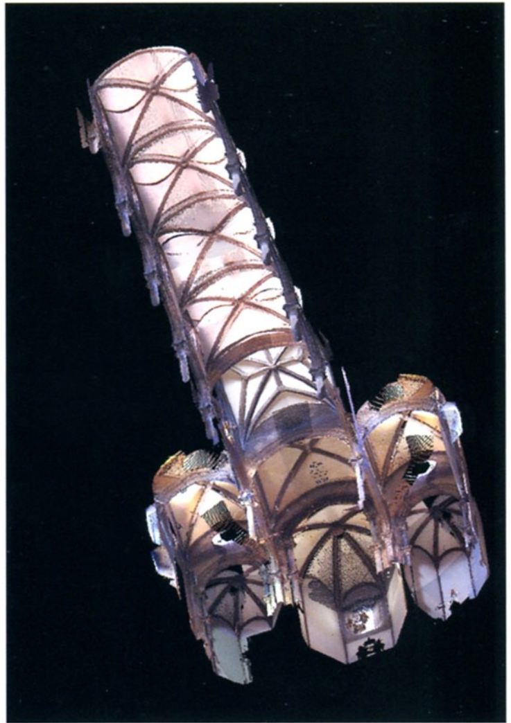
36. Scansione laser eseguita all'interno della chiesa.
