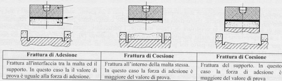
Schema 1. Le tre possibili modalità di lesione malta-piastra
