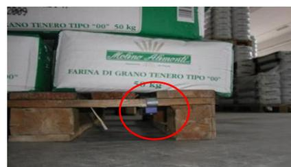
operativi controller RFID per la rilevazione automatica di detti tag e, quindi, pallet ad essi associati. Il sistema gestionale memorizza la packing list collegata al numero del pallet ed alla matricola del transponder installato sul pallet stesso.
