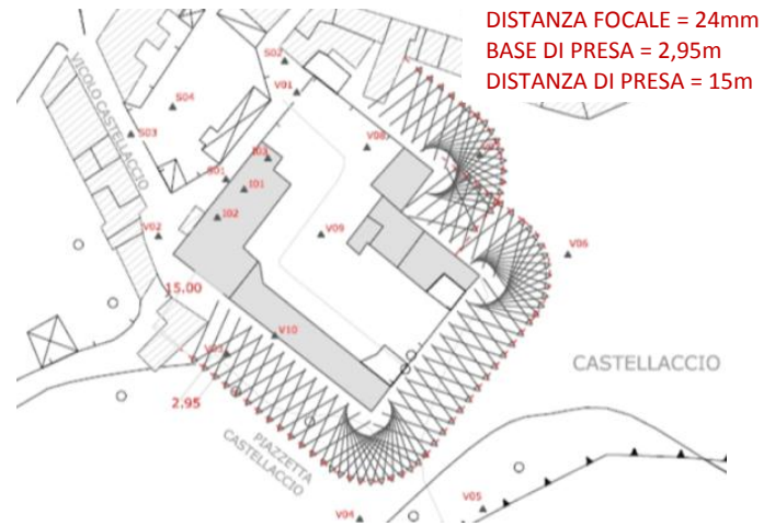
Fig. 5 Schema delle prese per il blocco fotogrammetrico
