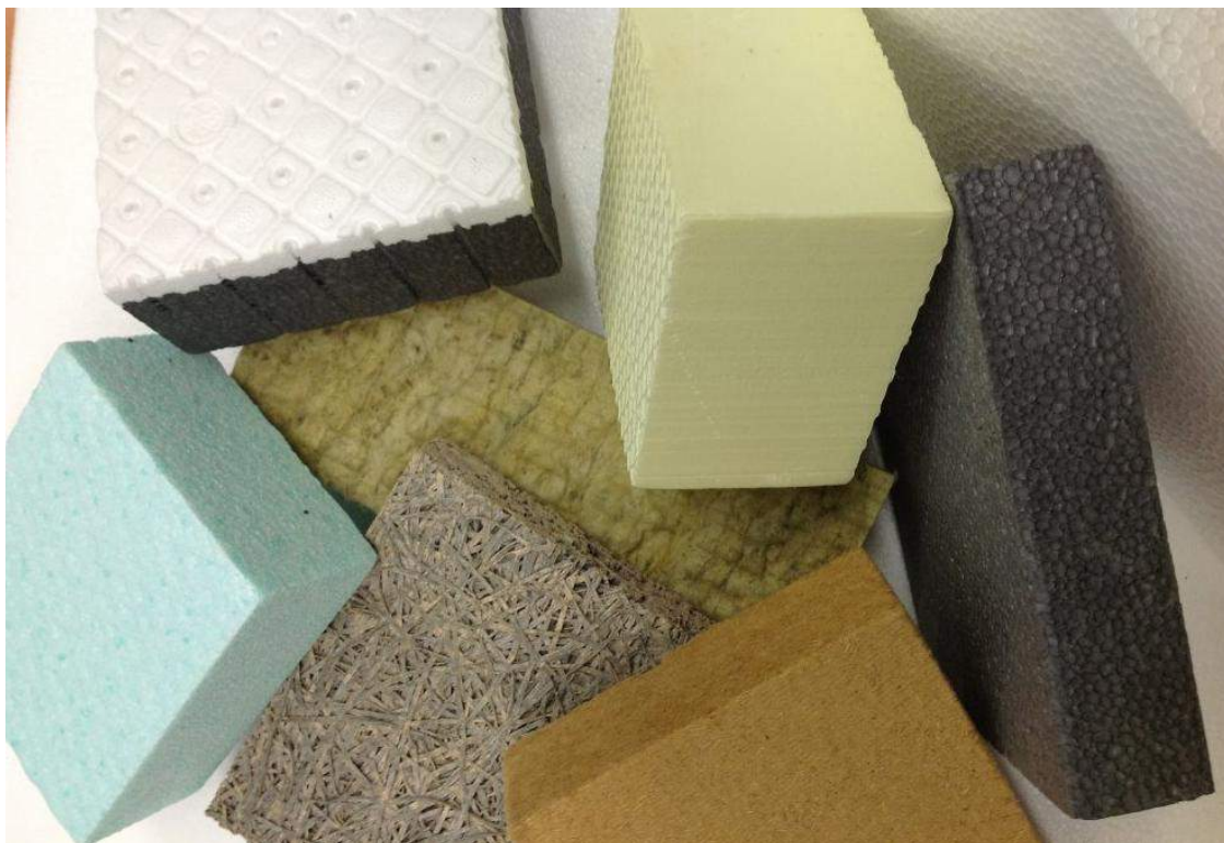
Fig. 6.8 - Campioni di materiale isolante diffuso in commercio e, in particolare, nel settore edilizio: lana di roccia, lana di legno, lana di legno mineralizzata, EPS, EPS con grafite, ecc. © Isoltop.
