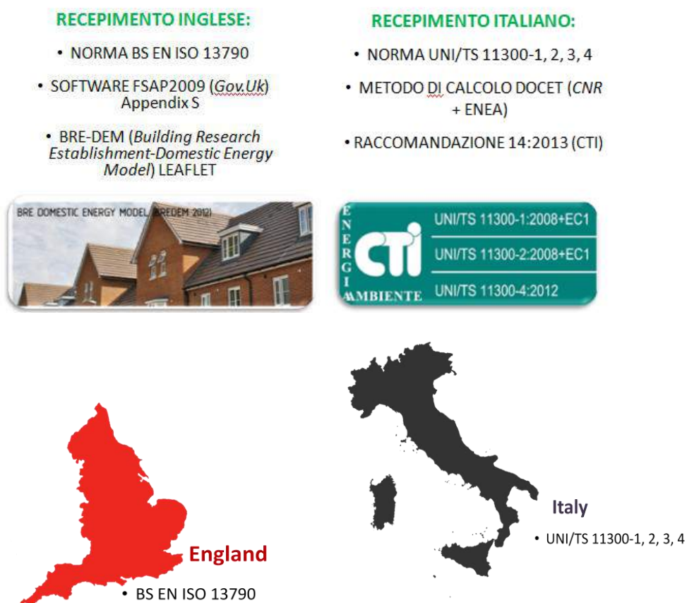
Fig. 4. Schema normativo di riferimento per la metodologia di calcolo delle prestazioni energetiche degli edifici.
