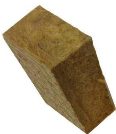
Figg. 6.18 e 6.19 - Foto di un campione in lana di roccia dello spessore di 80 mm e schema riassuntivo delle applicazioni più usuali. © Anit.
