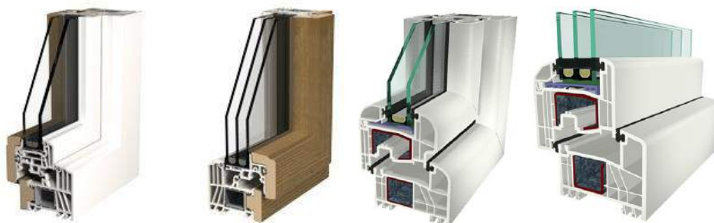
Figg. 6.21-24 - Rassegna di alcune tipologie di infisso composto da vetrocamera con una o due camere e telaio, rispettivamente in legno-PVC, legno e alluminio con taglio termico. © Finestrafacile.
