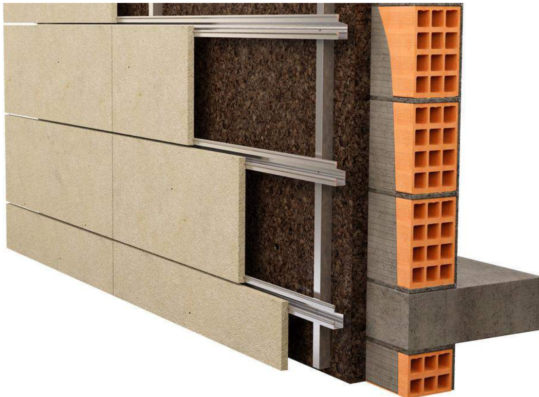
Fig. 6.5 - Schema tridimensionale di facciata ventilata con l'utilizzo di materiale isolante nell'intercapedine.
