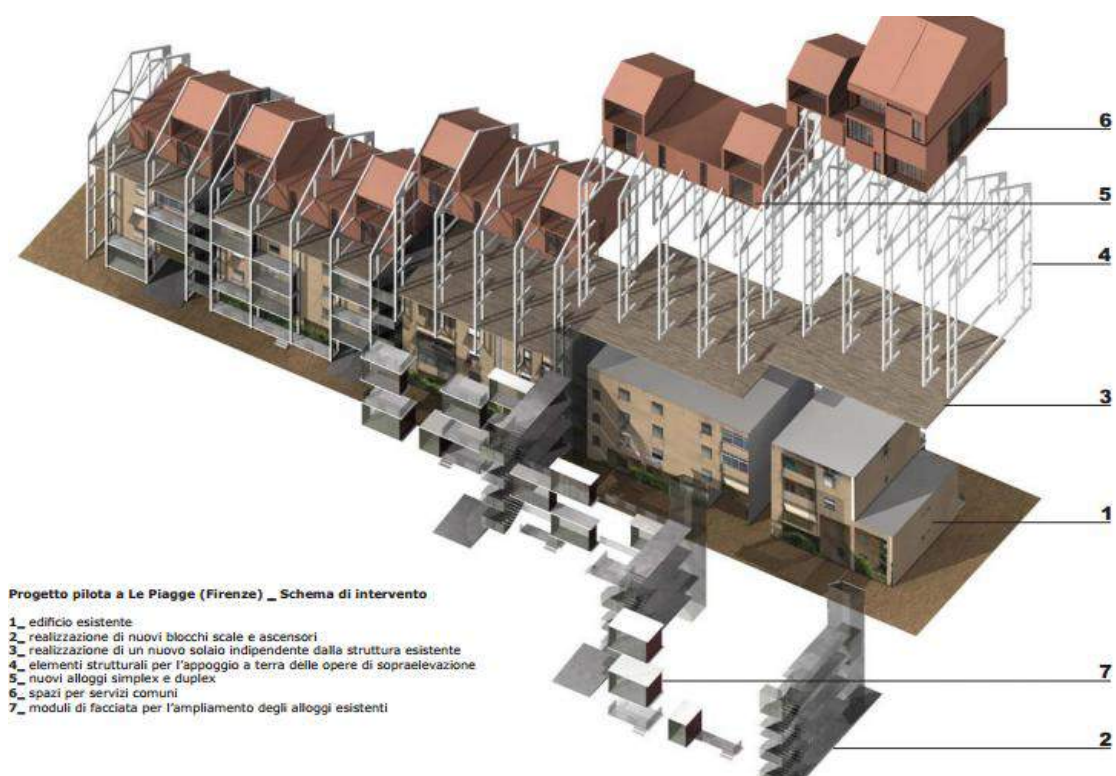
Fig. 3.19 - Esploso assometrico del complesso dopo l'intervento di retrofit energetico ©Comune di Firenze
