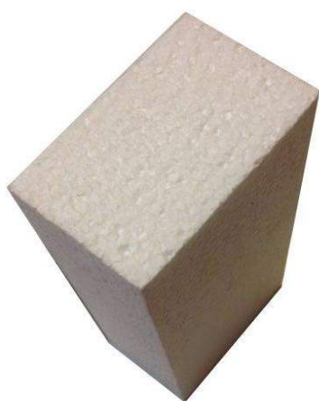
Figg. 6.15 e 6.16 - Foto di un campione in EPS dello spessore di 80 mm e schema riassuntivo delle applicazioni più usuali. © Anit.
