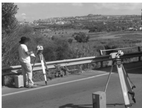
Figura 13 – Autolivelli digitali per il monitoraggio
