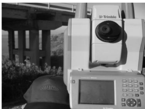
Figura 14 - Stazione totale per il monitoraggio degli abbassamenti
