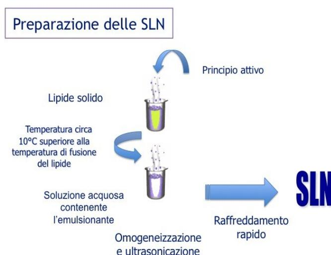
**Figura 8.** Preparazione di SLN con il metodo dell'omogeneizzazione ad alta prestazione e sonicazione.
