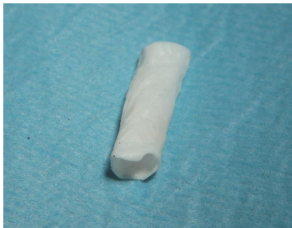
Figura 9. Scaffold tubulare biorassorbibile
