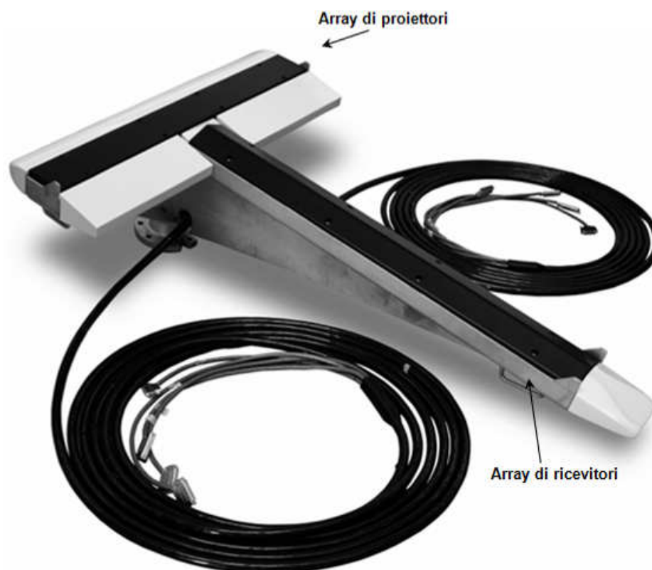
Fig. 2.12: Testa sonar del SeaBat 8160 (proiettore e idrofono).
