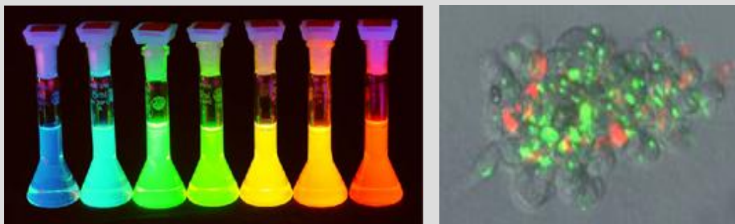
A sinistra quantum dots dello stesso materiale, (in questo caso, seleniuro di cadmio in sospensione CdSe), quelli rossi hanno dimensione maggiore rispetto agli altri, fino all'azzurro. A destra esempio di una cellula investita da quantum dots metallici.
