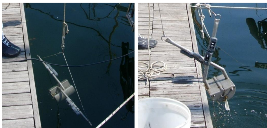
Figg. 17, 18 – Campionamento dei sedimenti mediante l'uso della benna Van Veen.
