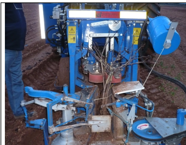
Foto 51: Operazione di estirpazione barbatelle.
