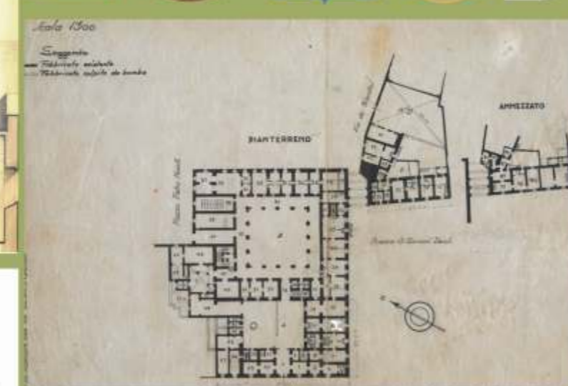
Planimetria piano terra con indicate le zone colpite dai bombardamenti della seconda guerra mondiale -11' R.I. (Domenico Militari) G. Spallino 1944
