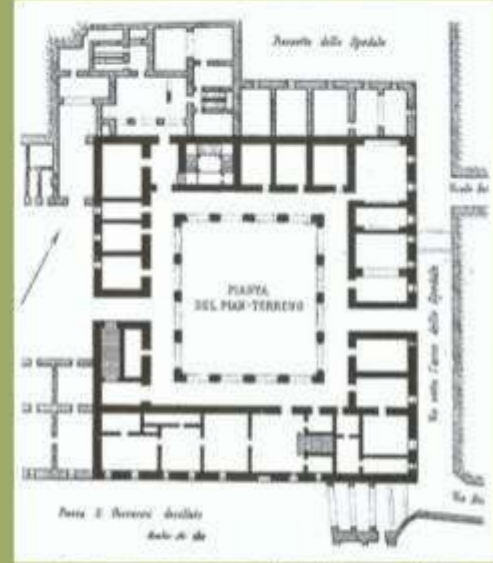
Matteina piano terreno con l'indicazione grafica delle trasformazioni strutturali (da Botta 1997, 117-118, R.I. Domenico Milanese)
