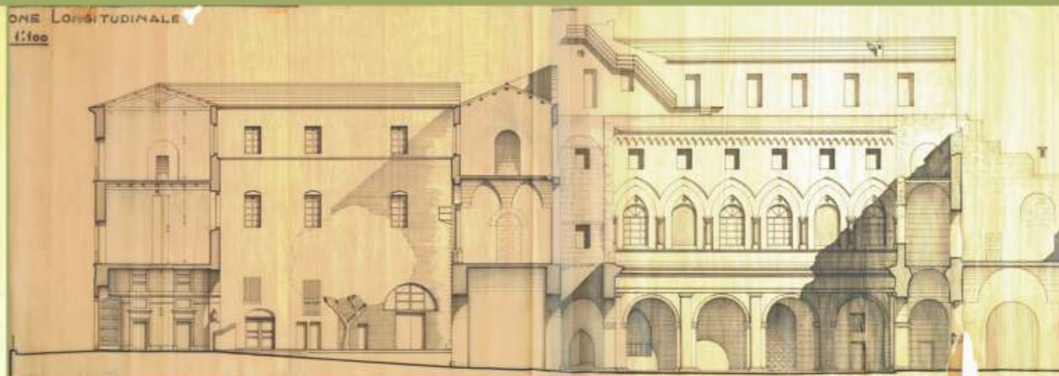
Sezione Prospetto longitudinale di tutto il complesso con indicazione dell'ala orientale che venne subito durante i bombardamenti della seconda guerra mondiale, anni '40-'11' R.I. (Domenico Militari)
