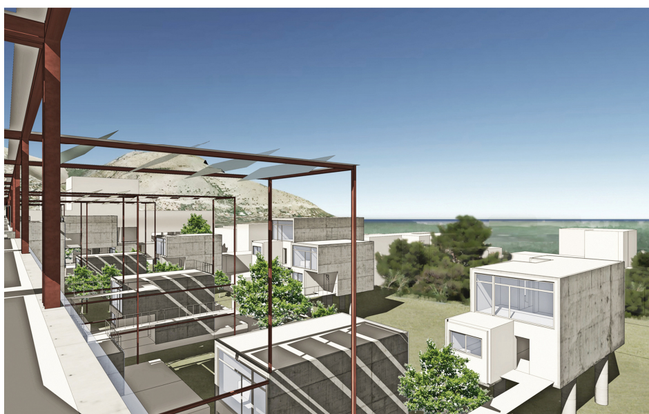
5. I pannelli solari ombreggiano terrazze e corti interne.
