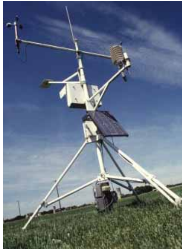
Figura 2.23 - Stazione agro-meteorologica standard per la misura delle variabili meteorologiche
