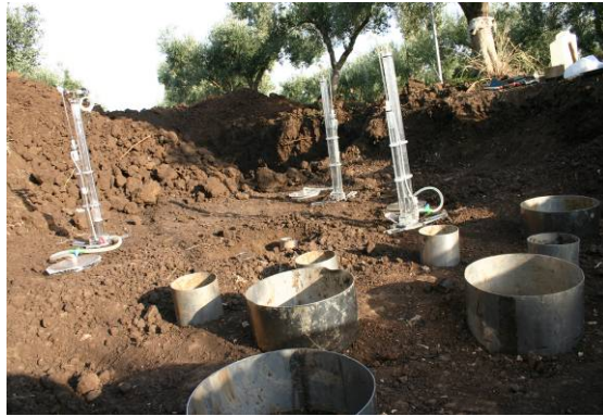
Figura 5.6 - Installazione ( z=-60 cm) per la misura della conducibilità idrica saturata (metodo SFH) e per quella prossima alla saturazione (metodo del tension infiltrometer)
