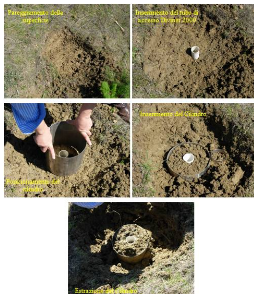
Figura 5.10 - Fasi del prelievo del lisimetro utilizzato per la calibrazione del sensore Diviner 2000
