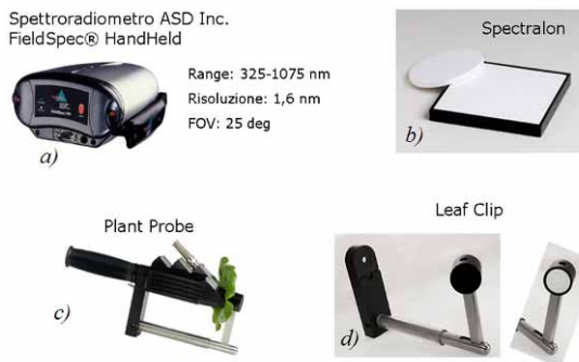
Figura 2.17 - Spettroradiometro da campo a), superficie in spectralon per l'ottimizzazione del sensore b), sonda a contatto c) e leaf clip background d)
