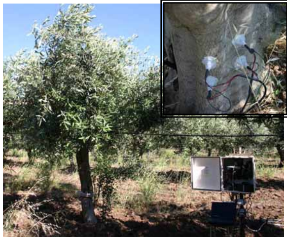
Figura 5.15 – Stazione per la misura dei flussi linfatici con particolare dell'istallazione
