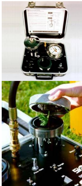
Figura 5.12 - Camera di Scholander per la misura dei potenziali idrici nella pianta
