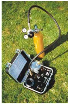
Figura 2.11 - Camera di Scholander per la misura del potenziale idrico xilematico
