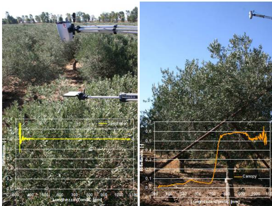
Figura 5.13 - Acquisizione dello spettro di riferimento (a sinistra) e della firma spettrale a scala di canopy (a destra)
