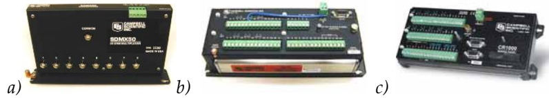
Figura 2.5 - a) Multiplexer per la gestione di più sonde TDR e Dataloggers b) Campbell CR10X c) Cr1000 per la permutazione e l'immagazzinamento dei dati
